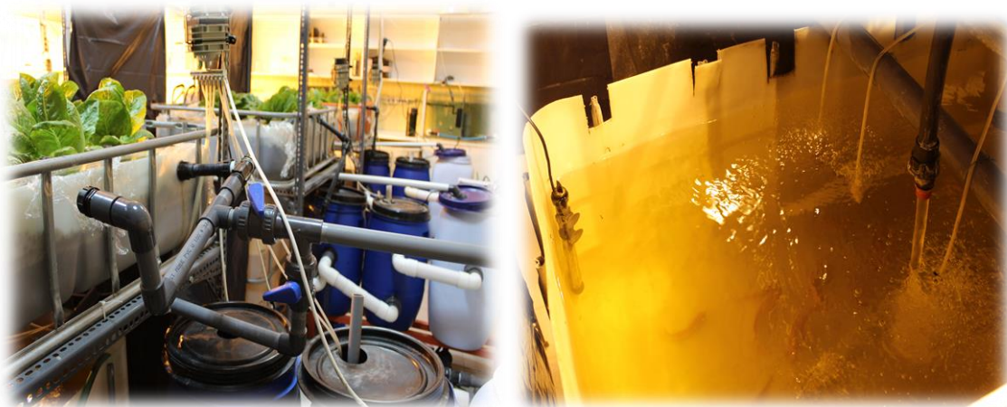
Εικόνα 3: Ενυδρειοπονικό σύστημα εργαστηριακής κλίμακας με καλλιέργεια μαρουλιού (αριστερά) και εκτροφή τιλάπιας (δεξιά).
